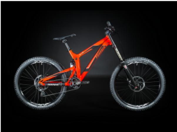
Der Fokus bei der Weiterentwicklung des **RAGE 2015** lag auf der Gewichtsreduktion sowie der Steigerung der Laufruhe bzw. Stabilität ohne jedoch die für das **RAGE** charakteristische Agilität und Wendigkeit negativ zu beeinflussen. So wurden grundlegende Eigenschaften wie das bewährte PRO10 Suspension System, der Federweg, Tretlagerhöhe und Kettenstrebenlänge unverändert beibehalten.
