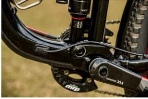
Während die Vorgänger-Modellreihe des Reign mit 26-Zoll-Laufrädern am Hinterbau über 152 mm Federweg verfügte, hat der Reign 27.5 Prototyp mit seiner stark modifizierten oberen und unteren Umlenkkippe beim Maestro-Federungssystem etwas mehr Reserve zu bieten.
