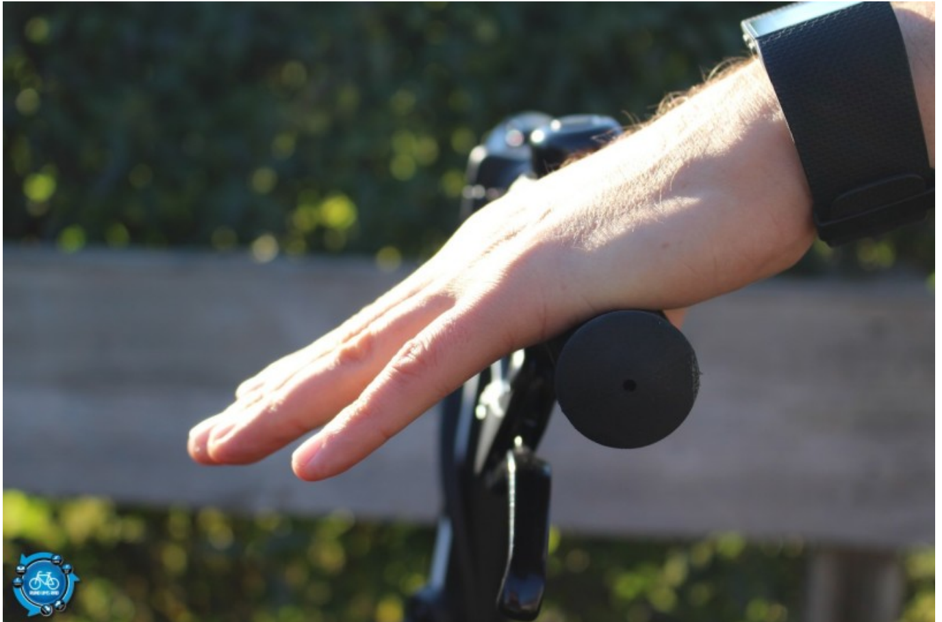
Optimale Position für den Bremshebel in Verlängerung des Armes ohne abgeknicktes Handgelenk oder Finger
