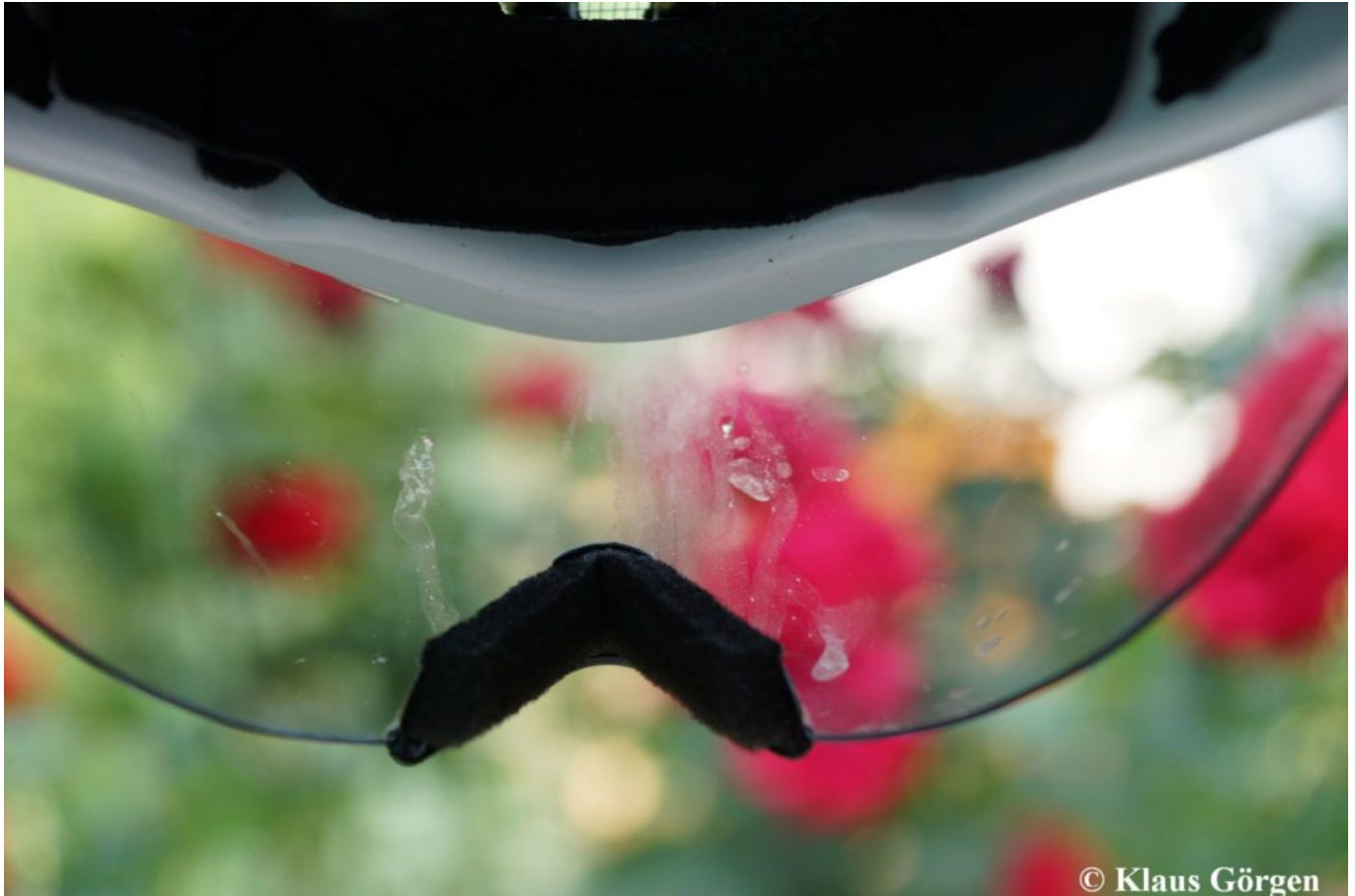
Casco-SPEEDairo: Schweißspuren nach zwei Stunden Fahrt
