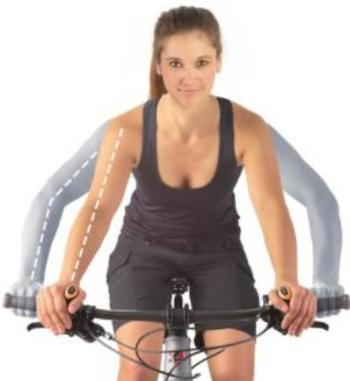
Doch wer ist schon täglich mit dem Messer unter der Kehle auf CC Strecken unterwegs? Geht es nach den Münchnern Ergonomie Spezialisten von SQlab, haben Barends definitiv eine messbare Daseinsberechtigung. Montiert zwischen Bremsgriff und Griff ermöglichen sie eine aerodynamische Haltung auf dem Rad, eine zweite Griffposition und zudem stets sichereres Bremsen. Die Bremsgriffe bleiben permanent erreichbar.
