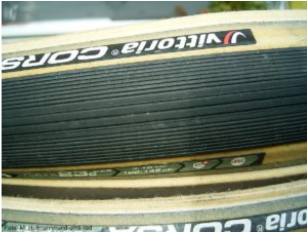
Vittoria Corsa Graphene G+: Das Profil vom Vorderrad nach 3.700 km
