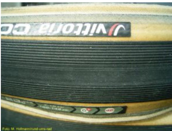
Vittoria Corsa Graphene G+: Nach 3.700 km deutliche Gebrauchsspuren am Hinterrad
