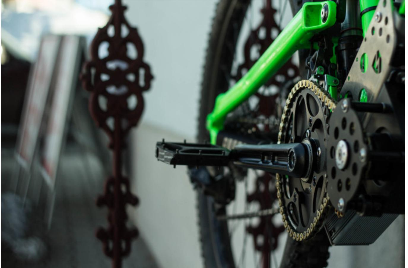
Massive goldene Kette zur Kraftubertragung am Ego-Kit.
