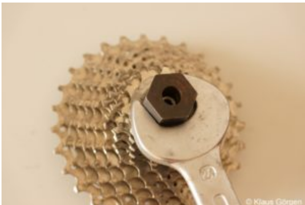
Elite Drivo: Ritzelpaket festziehen
