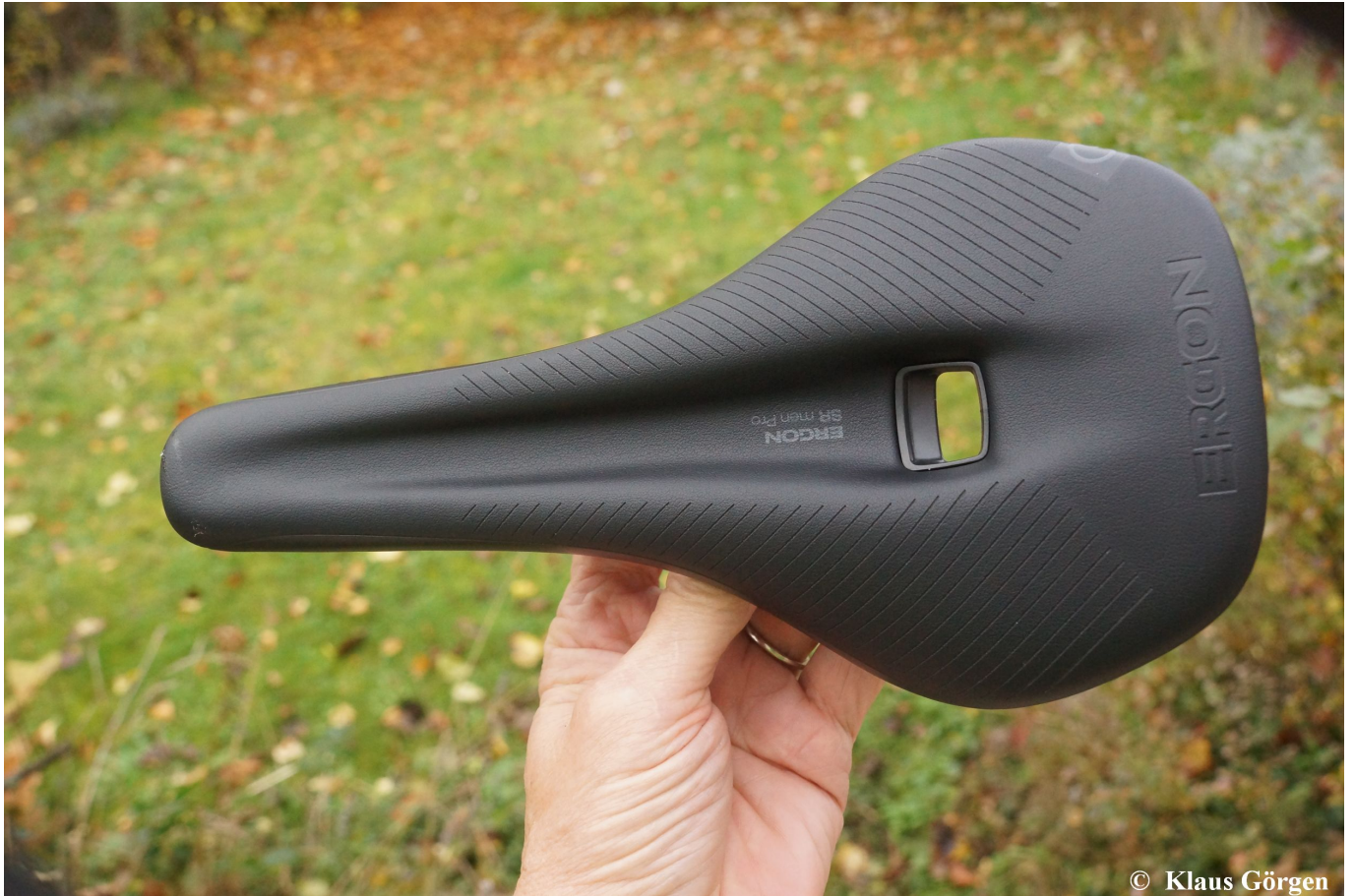
So sieht er aus, mit Entlastungskanal
