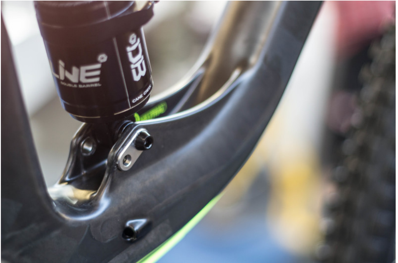
Cane Creek InLine am Heck und 2 Möglichkeiten zur Verstellung der Geometrie
