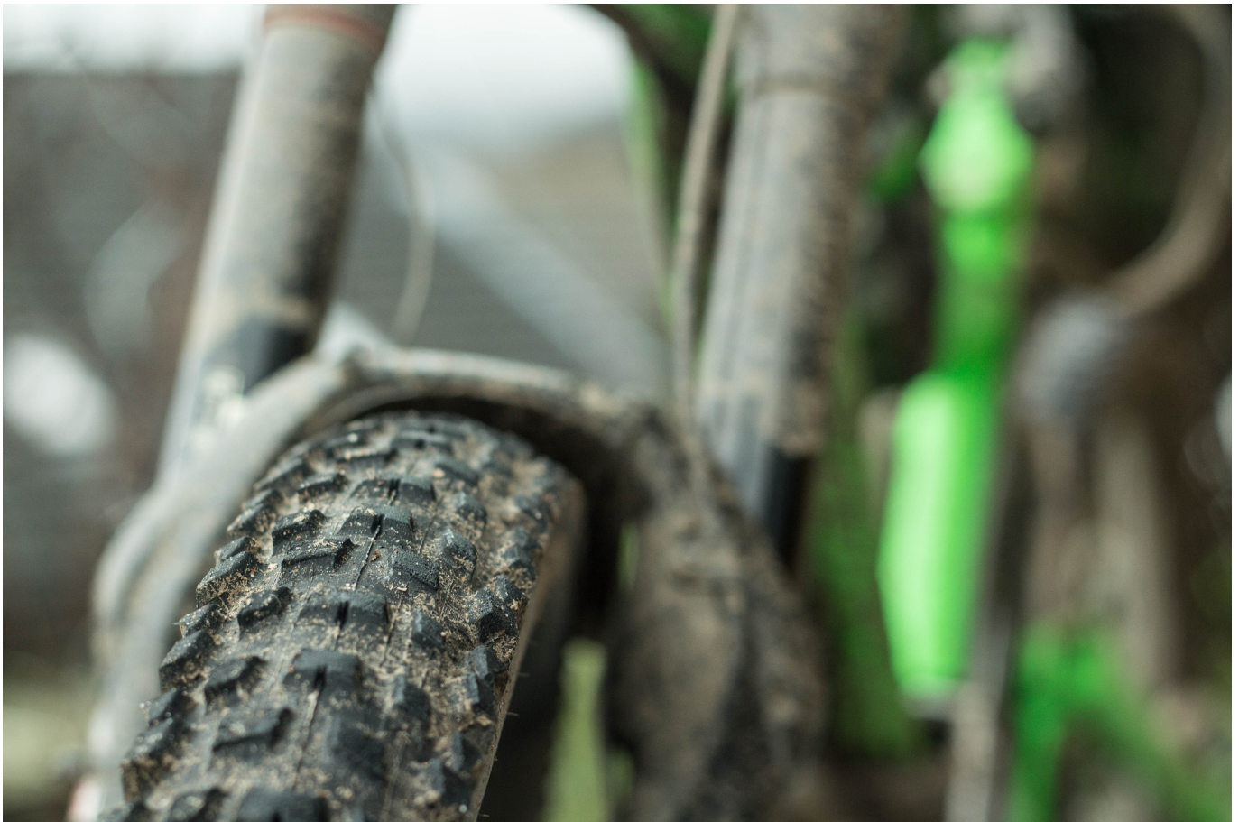
Griffiges Profil an den Seiten und ein flacheres in der Mitte (nach 2.000 km)
