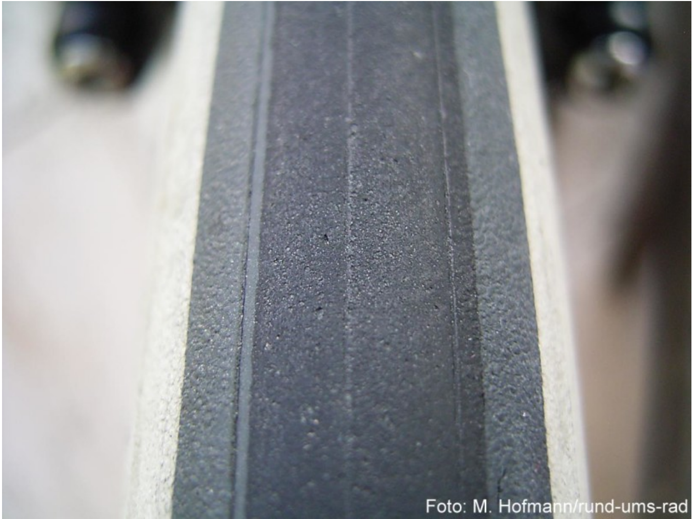
Lauffläche Vorderrad nach 2.000 Kilometern
