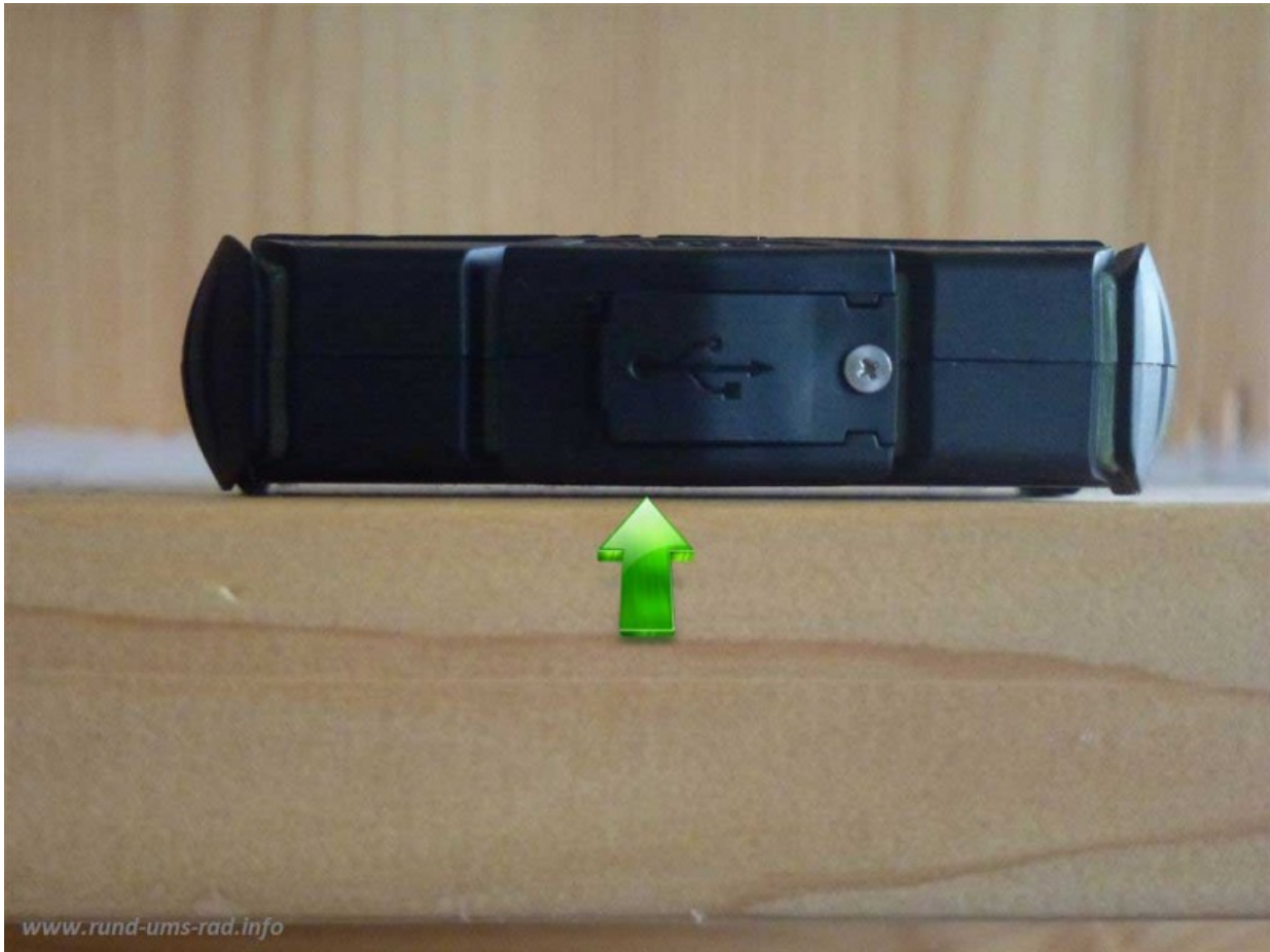
Luftspalt bis zum Display
