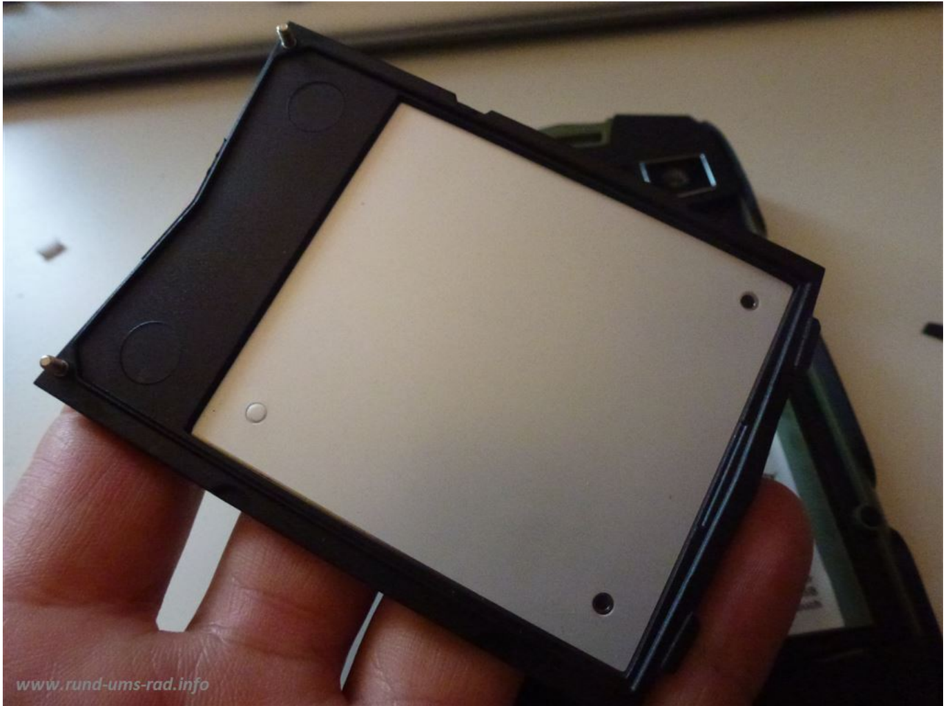
Akkudeckel mit Dichtung
