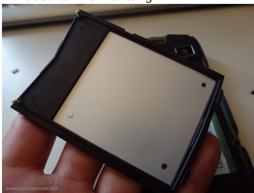
Akkudeckel mit Dichtung
