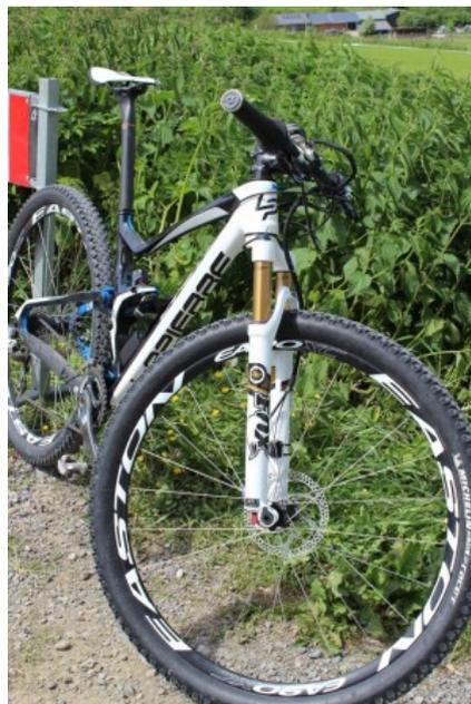
Die forschenden Hersteller benötigten 5 Jahre für die Entwicklung des Fahrwerkssystems, dass die Dämpfereinstellung je nach einwirkender Kräfte in die Gabel und einen Sensor im Tretlager regelt. Es besteht aus einem Beschleunigungssensor in der Federgabel, der die Einfederungsgeschwindigkeit der Gabel misst,
