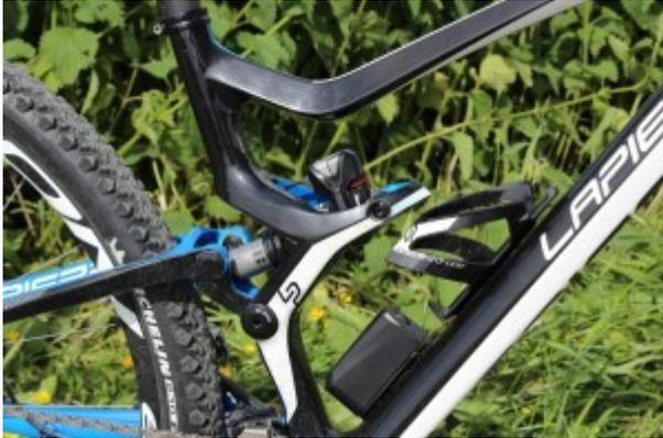
Lediglich der Gabellockout muss traditionell per Lenkerhebel betätigt werden. Passend zum Dämpfer stehen bei der verbauten Fox CTD ebenfalls 3 Modi bereit. Vom automatischen Ei-Shock System ist diese aber wie gesagt ausgeschlossen. Damit kann man aber Leben, denn die meiste Kraft durchs Wippen geht definitiv über den Dämpfer verloren, was wohl das springende Kaufargument fürs Hardtail ist.... oder war?
