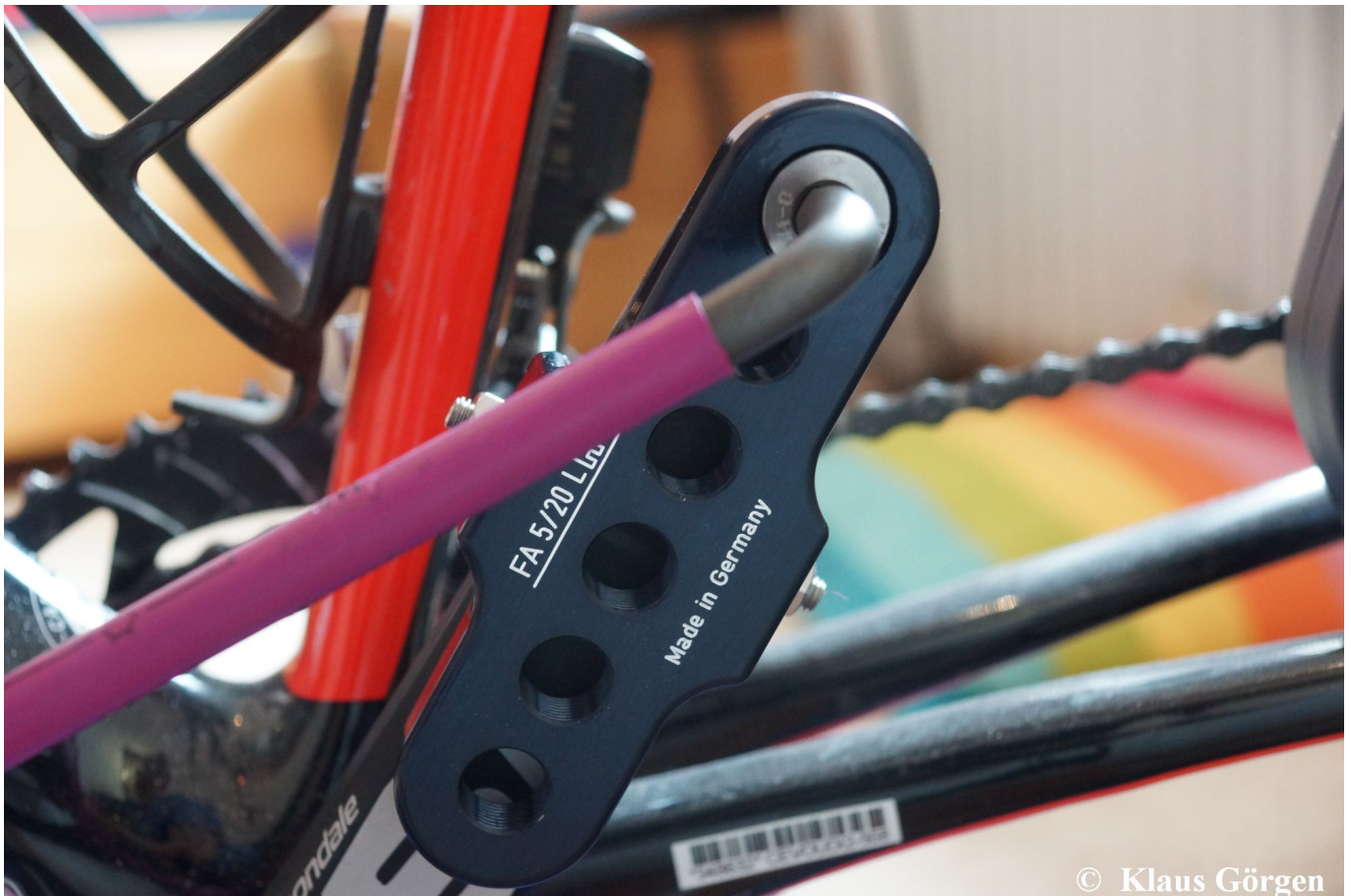
FA 5/20 L: Anstelle des Pedals anschrauben
