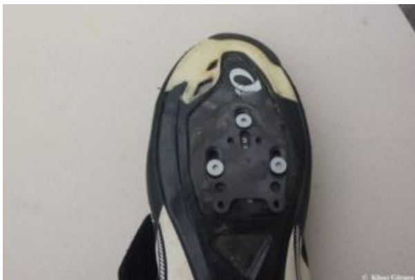
Montage der Schuhplatte Teil1, Metallplatte anschrauben
