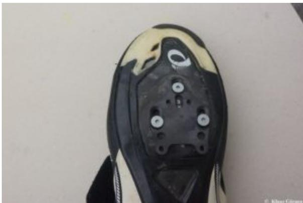
Montage der Schuhplatte Teil1, Metallplatte anschrauben
