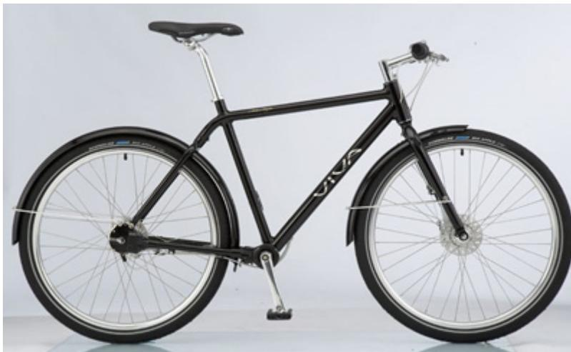
Der verwendete Kardanantrieb mit der Shimano 7-Gangschaltung arbeitet auch nach mehr als 15.000 km immer noch wartungsfrei und die verwendeten Scheibenbremsen machen auch im Stop-and-Go-Betrieb keinesfalls schlapp.
