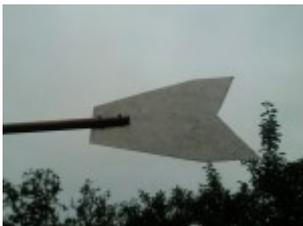
Für den Ruderstab habe ich ein Reststück Kupferrohr verwendet. Dieses habe ich auf einer Seite längs eingesägt, sodass das Ruder eingesteckt werden kann.
