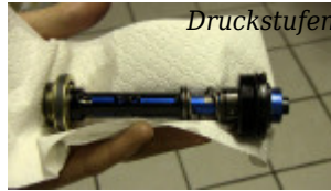
Druckstufeneinheit herausziehen. Oben abkippen damit das Öl anlaufen kann.
