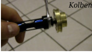
Low Speed Druckstufe Austrittsöffnung. Hier vollständig geöffnet (Querschnitt maximal)
