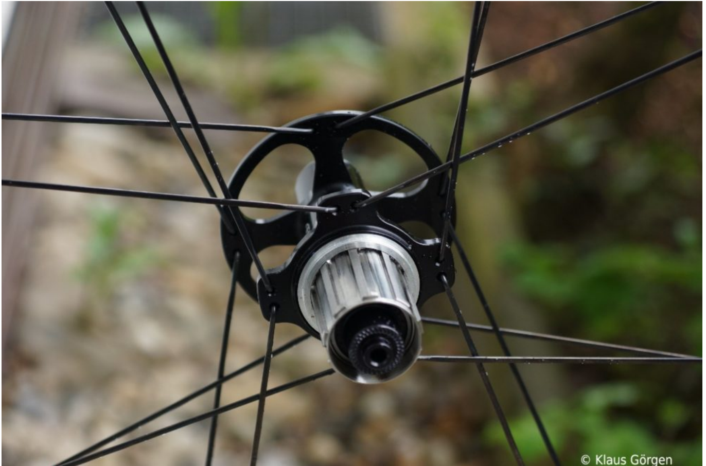
Rolf Prima Ares6 Hinterradnabe mit Freilaufkörper
