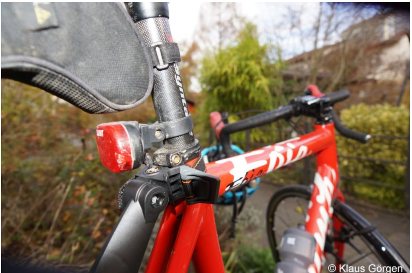
SKS S-Blade befestigen (1):Spannbügel einhängen
