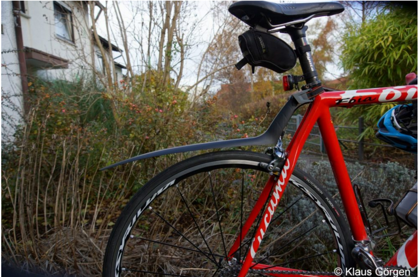
SKS S-Blade fertig montiert
