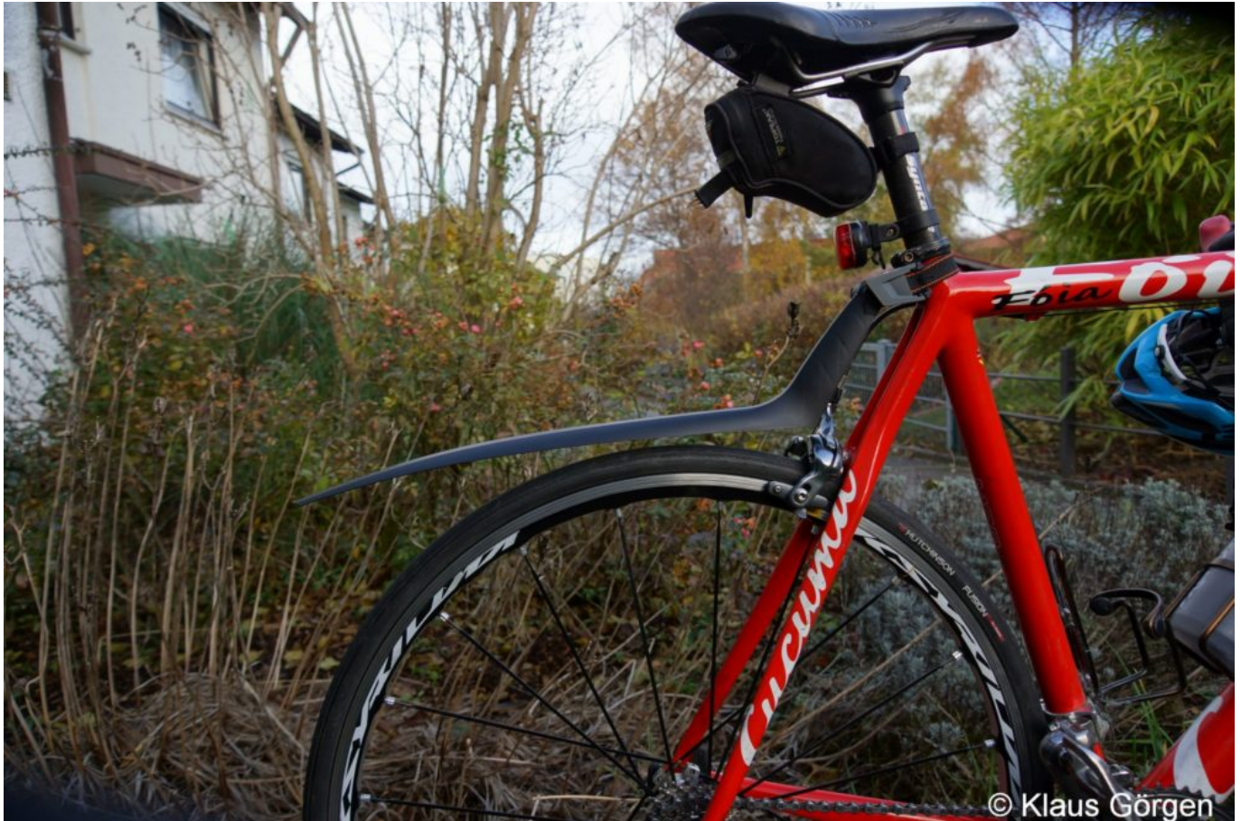
SKS S-Blade fertig montiert
