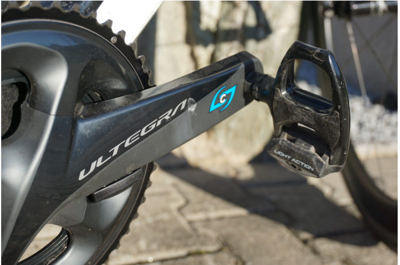
Shimano Ultegra Kurbel mit Stages Powermeter
