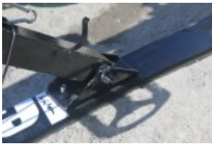
Die Ski sind via Schnellspanner befestigt
