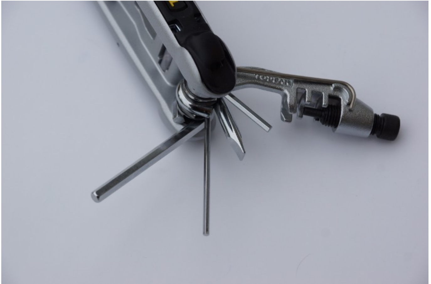
Schraubendreher, drei Innensechskant, Kettennieter mit -fixierhaken
